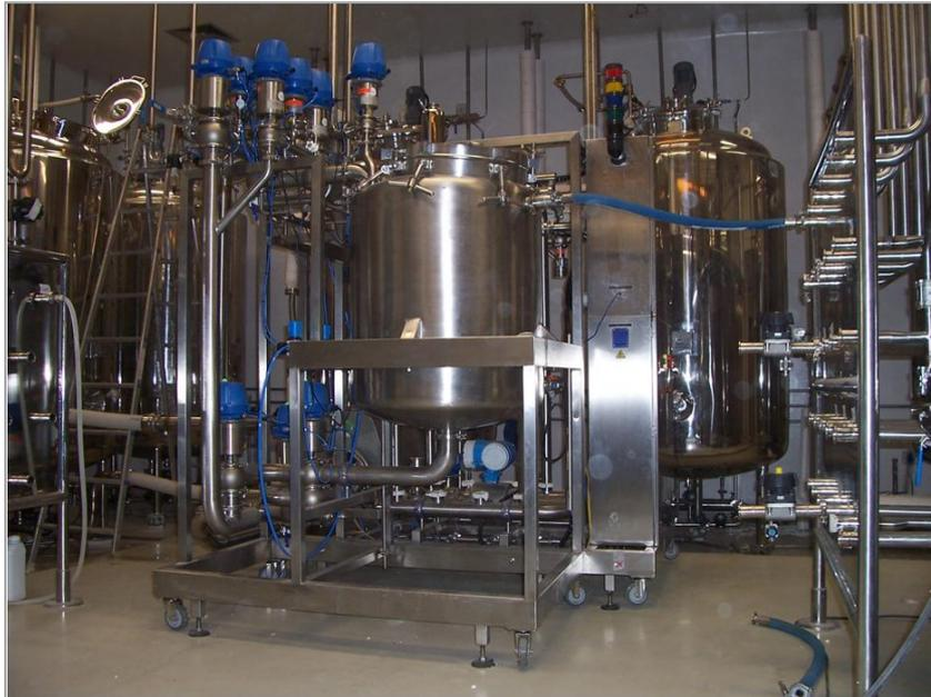
*Fig.12: Planta de elaboración de vacuna anti-aftosa. Sistemas de tanques y filtros empleados en la concentración y purificación; en azul se observan válvulas automáticas para cerrar caudales de 3 pulgadas de diámetro, conectadas por cable de red a una PC situada a 10 mts de distancia. Estos sistemas automáticos brindan las variables de proceso on line y un cálculo del factor de concentración.*
