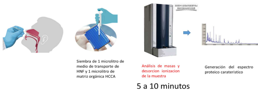
Figura 6. Esquema general de la obtención de perfiles proteicos a partir de hisopados nasofaríngeos en MALDI-TOF.
