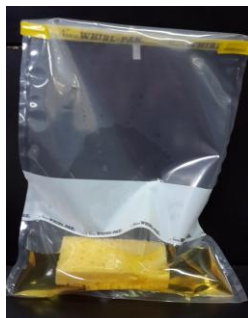
Figura 3. Bolsa de Stomacher con esponja sumergida en TSBm.
