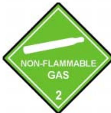
Fig. 3. Etiqueta indicadora de envíos en "Nitrógeno Líquido".
