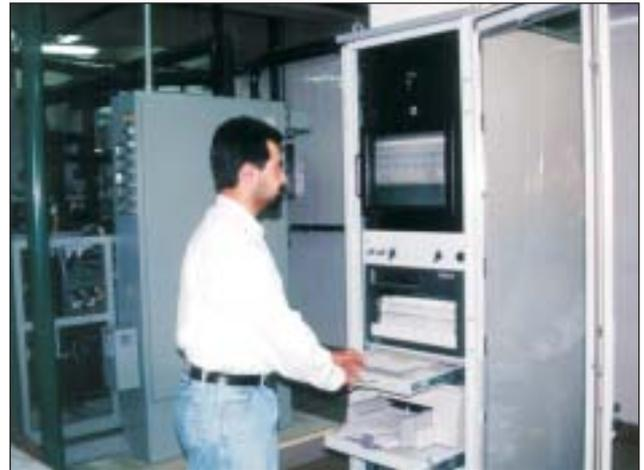
Figura 8. Operador fijando parámetros de un ciclo de liofilización en la interfase PLC del liofilizador.
