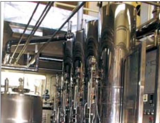
Figura 7. Vista de los cuatro efectos del destilador de agua para la obtención de agua para inyectables y vapor limpio.
