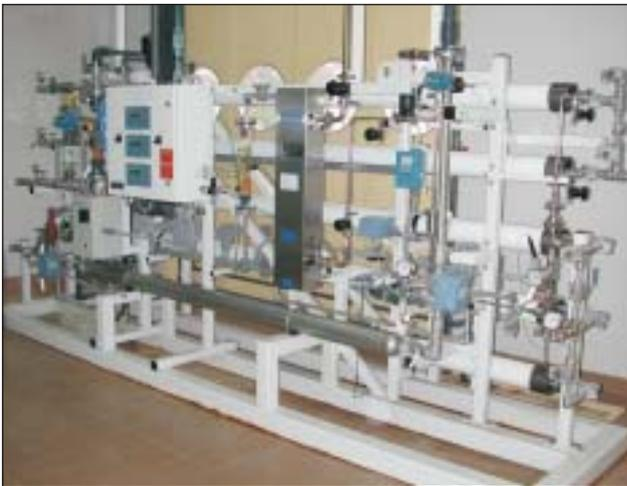
Figura 6. Vista del equipo de doble ósmosis reversa para el tratamiento del agua a utilizar en reactivos y procesos.
